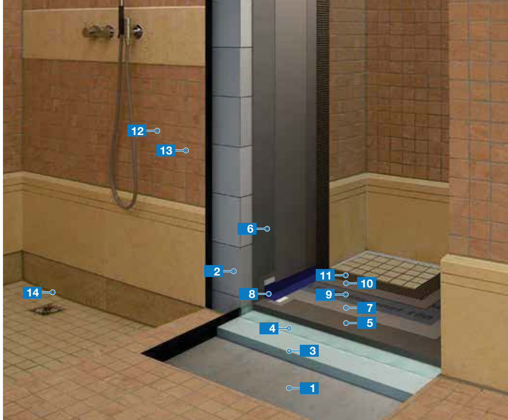
Rendszer természetes kövek fektetéséhez nedves környezetben
