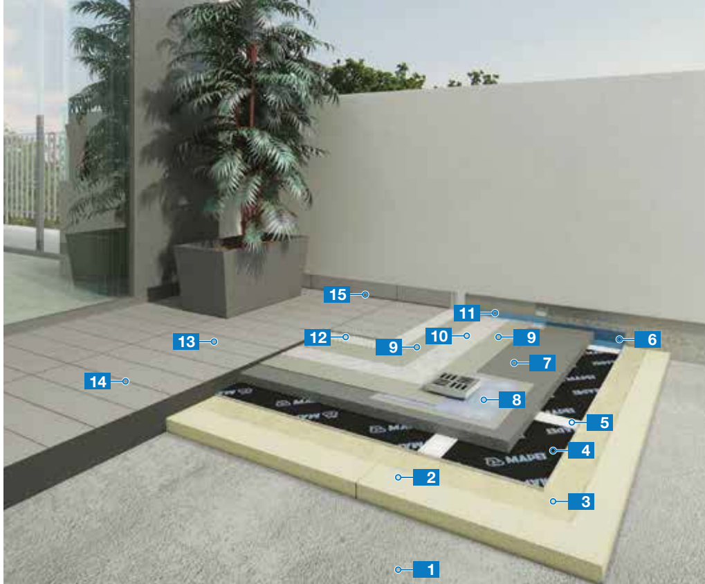
Vízszigetelés és kerámiaburkolat fektetése teraszokon lépéshang elleni szigetelőrendszerrel
