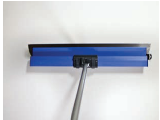
Mennyezetben is széles simítóval elhúzott 2-3 mm vastag glettelés, vékonyvakolat.
